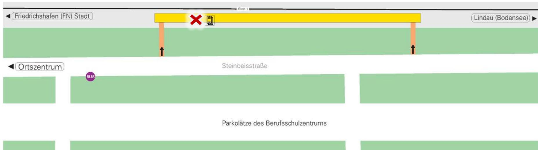
An Bahnhaltetpunkten mit maximal zwei Bahnsteigen sind die Terminals in der Regel direkt auf den Bahnsteigen positioniert (Stelen).
