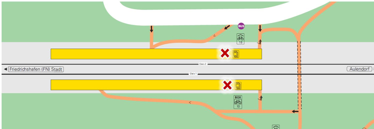
An Bahnhaltetpunkten mit maximal zwei Bahnsteigen sind die Terminals direkt auf den Bahnsteigen positioniert (Stelen).
