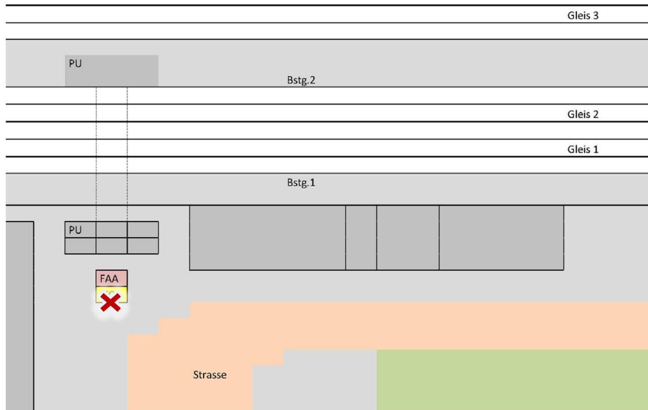
An Bahnhaltetpunkten mit maximal zwei Bahnsteigen sind die Terminals in der Regel direkt auf den Bahnsteigen positioniert (Stelen).
