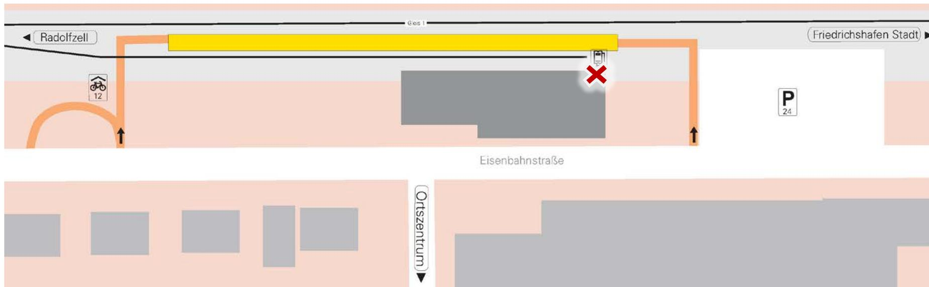
An Bahnhaltetpunkten mit maximal zwei Bahnsteigen sind die Terminals in der Regel direkt auf den Bahnsteigen positioniert (Stelen).
