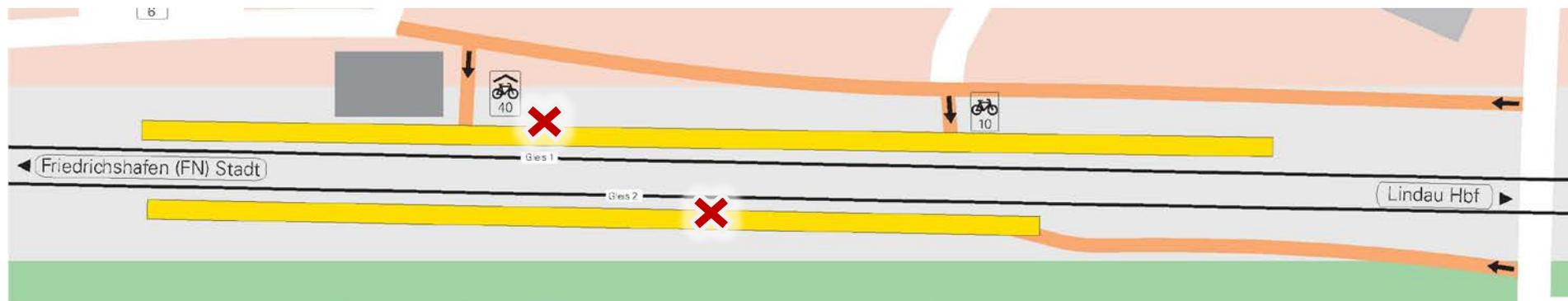
An Bahnhaltungen mit maximal zwei Bahnsteigen sind die Terminals in der Regel direkt auf den Bahnsteigen positioniert (Stelen).
