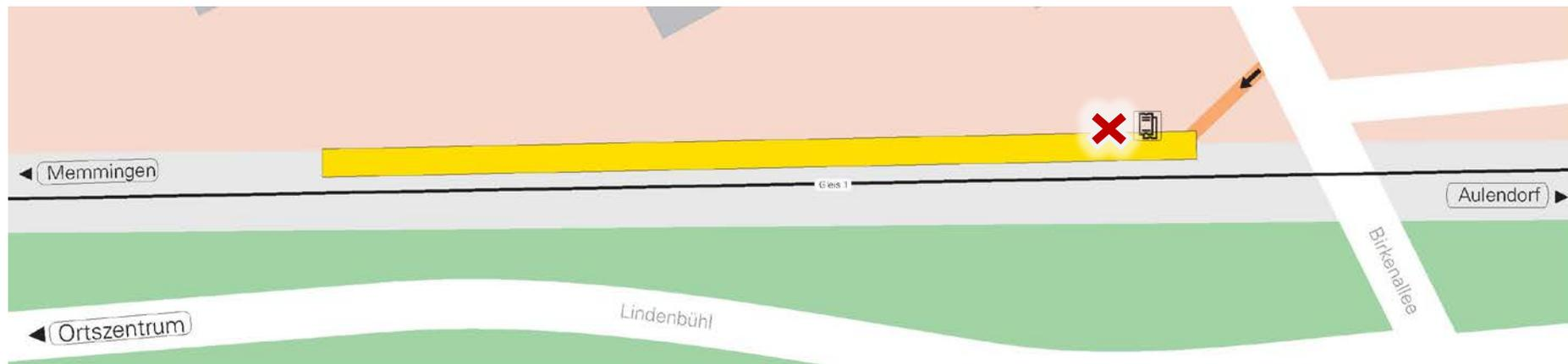
An Bahnhaltungen mit maximal zwei Bahnsteigen sind die Terminals in der Regel direkt auf den Bahnsteigen positioniert (Stelen).
